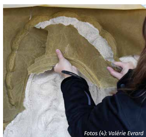
Ablösen der Schollen samt der gebundenen Verunreinigungen.
